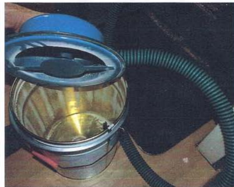
Syklon: Oppe i lokket sitter syklonen, uten noen bevegelige deler. Enkel, solid og effektiv.
